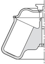
$r_{\max} = 137 \text{ mm}$ | 6100    | 5710                   | 6 $\times$ 250 mL | GS-TB-023           |
