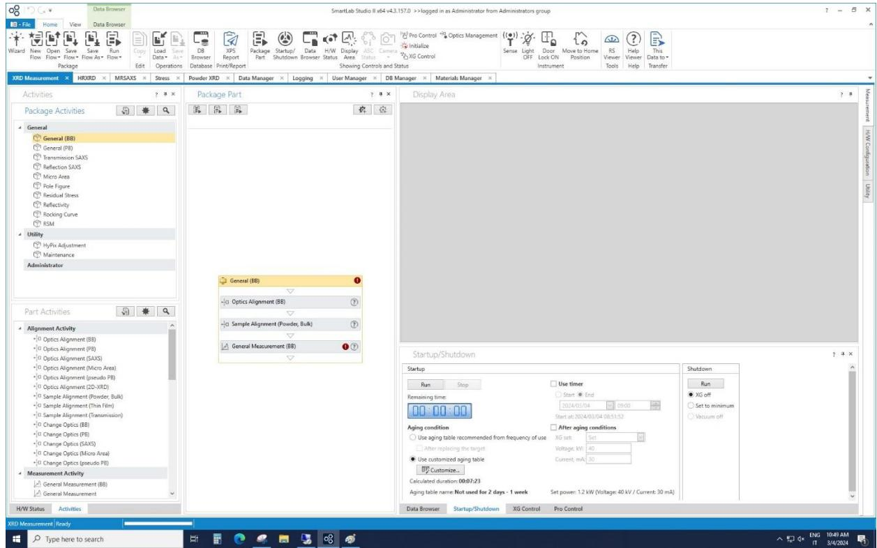
11. Procedere con l'allineamento delle ottiche nella geometria di misura scelta. E' possibile leggere le ottiche in uso sullo strumento dalla finestra *Customize Optics/ Set Current Optics*.
