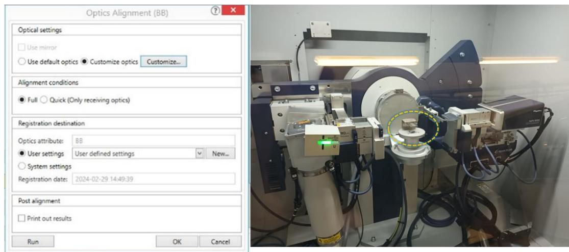
12. Procedere con l'allineamento del campione, *Sample Alignment*: esempio con vetrino (a) come porta campione ed esempio con piattino per wafer da 4'', che richiede l'introduzione del corretto valore di Tickness (campione + portacampione).
