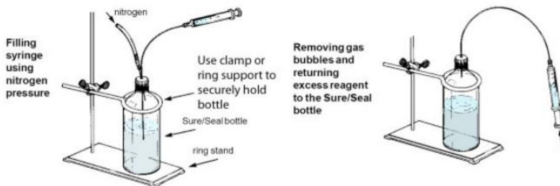
*Il trasferimento tramite canula* avviene applicando una pressione positiva all'interno del reattore contenente il reagente di interesse. Questa pressione può essere applicata chiudendo momentaneamente il flusso di gas inerte all'interno del recipiente di reazione e solo dopo essersi assicurati che la canula si trovi al di sotto del livello di liquido del reagente da aggiungere (vedi immagine). Si consiglia tuttavia un addestramento specifico in questi casi ad opera del PI.
