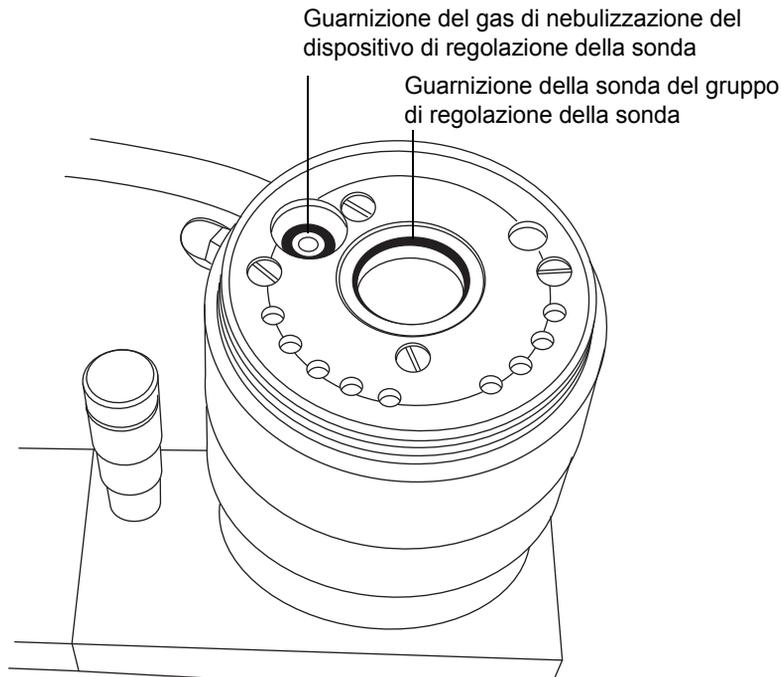
3. Utilizzando il kit di rimozione delle guarnizioni o-ring, rimuovere con cautela le seguenti guarnizioni dalla calotta della sorgente:
